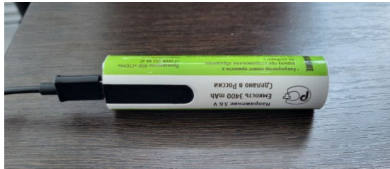
Рис.5. Зарядка аккумуляторной батареи
