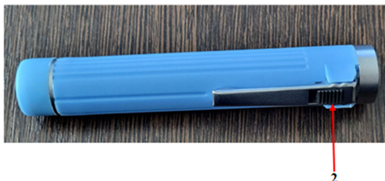
Рис.2. Рукоятка офтальмоскопа STERN Optoview. 2 – Кнопка включения питания.
